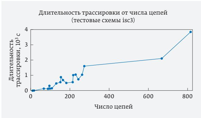
**Рис. 2.** Экспериментальная зависимость времени в секундах, затраченного на работу алгоритма трассировки, до полной разводки всего списка цепей от их количества
