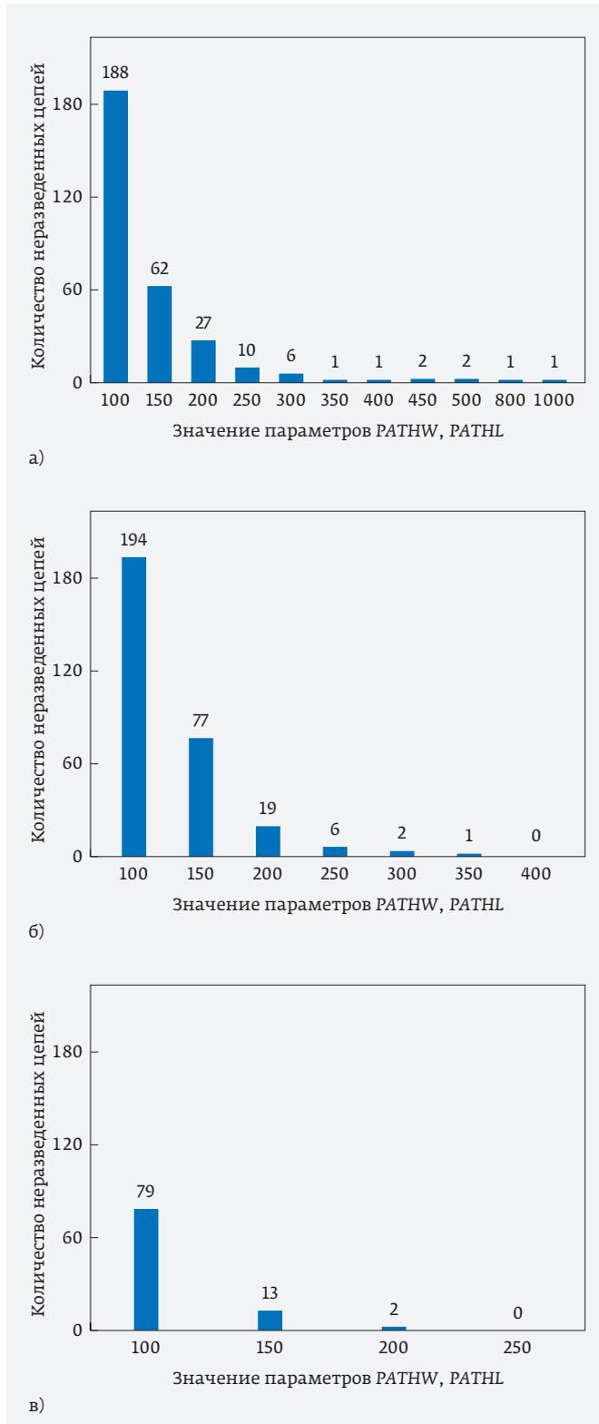
**Рис. 4.** Зависимость числа нетрассируемых цепей схемы 8051 от значений параметров PATHW и PATHL при фиксированных: а)  $VH = VP = 1,0$ ; б)  $VH = 1, VP = 0,5$ ; в)  $VH = VP = 0,5$
